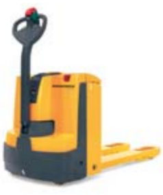
Akülü Transpalet, EJE 116-120 Taşıma mesafesi: Kısa Maks. kapasite: 2000 kg
