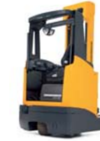
Reach Truck Seri C (Lastik Tekerlekli), ETV C16/C20 Maks. kaldırma yüksekliği: 7400 mm Maks. kapasite: 2000 kg
