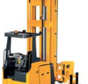
Akülü dar koridor istifleyici, ETX 513-515 Maks. kaldırma yüksekliği: 13000 mm Maks. kapasite: 1500 kg
