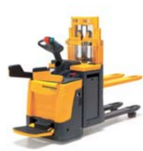
Akülü katlanabilir platformlu çift palet taşıyıcı istifleyici, ERD 220 Maks. kaldırma yüksekliği: 2560 mm Kapasite: 2000 kg
