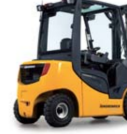
Dizel forklift, LPG'li forklift DFG/TFG 316-435s hidrostatik Maks. kaldırma yüksekliği: 7000 mm Maks. kapasite: 3500 kg
