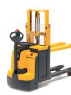
Akülü çift palet taşıyıcı istifleyici, EJD 220 Maks. kaldırma yüksekliği: 2560 mm Kapasite: 2000 kg
