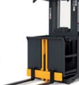
Akülü dikey sipariş hazırlayıcı, EKS 210/312 Maks. uzanma yüksekliği: 11345 mm Maks. kapasite: 1200 kg
