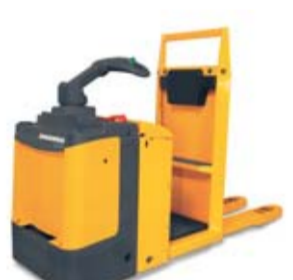
Akülü yatay sipariş hazırlayıcı, ECE 118 Maks. uzanma yüksekliği: 1. kat Kapasite: 1800 kg
