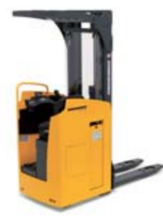
Akülü, sürücüsü oturabilen istif makinesi, ESC 214-316 Maks. kaldırma yüksekliği: 5350 mm Maks. kapasite: 1600 kg
