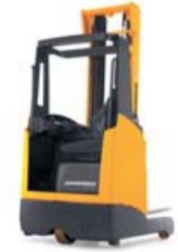
Reach Truck Seri 1, ETV 110/112/114/116 Maks. kaldırma yüksekliği: 9020 mm Maks. kapasite: 1600 kg
